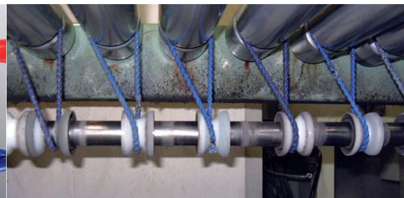
Napęd wałków podporowych w technologii transportu, niebieskimi pasami haczykowatymi PU
