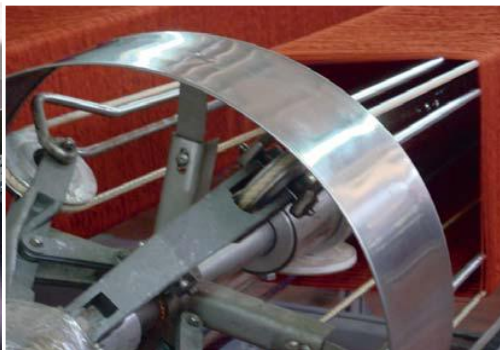
NOMEX-PTFE pasy wysokiego obciążenia w tekstylnej instalacji wykończeniowej
