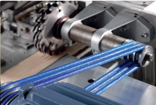
Bezkońcowe, elastyczne pasy okrągłe, niebieskie PU, w maszynie obrabiającej drewno
