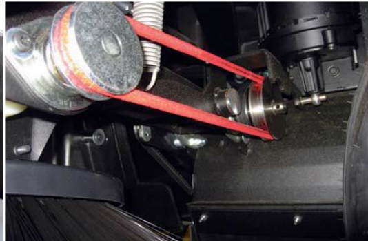
Boczny napęd szczotki w zamiatarce mechanicznej
