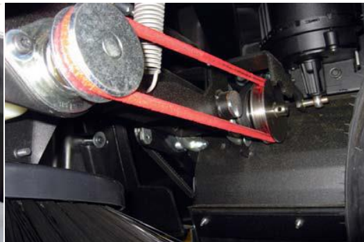
Boczny napęd szczotki w zamiatarce mechanicznej
