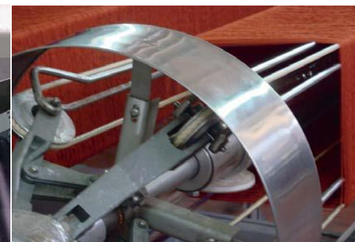
NOMEX-PTFE pasy wysokiego obciążenia w tekstylnej instalacji wykończeniowej
