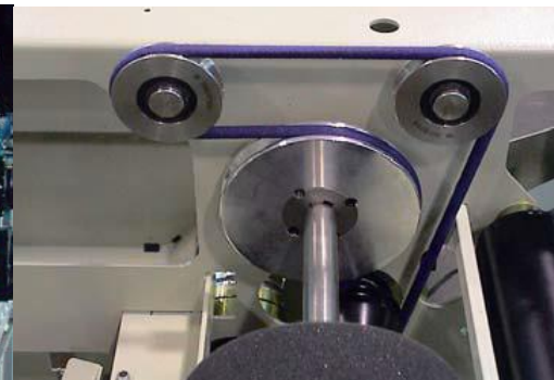
Napęd rolkowy w maszynie plecącej
