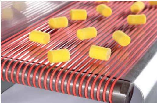
Poliestrowe pasy okrągłe PVA, czerwone, pracujące na maszynie transportowej
