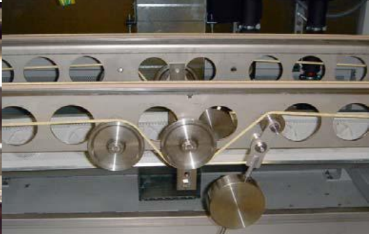
Bezkońcowe, okrągłe pasy nawijane wykonane z Kevlaru na linii transportowej obramowań
