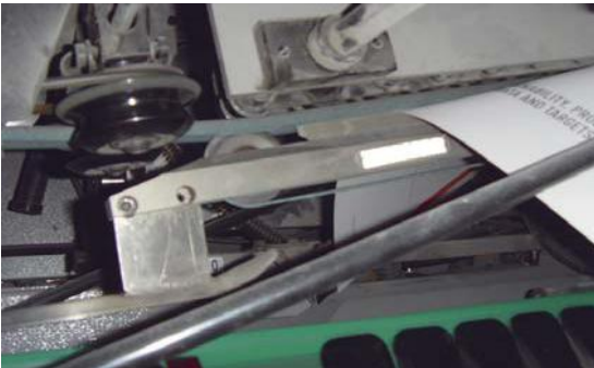
2,0 mm poliestrowy pas okrągły w maszynie zwijającej papier
