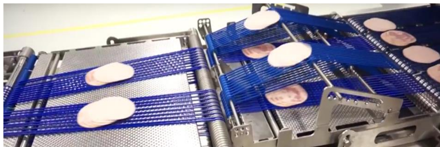
Overlapper für Aufschnitt mit verschiedenen Rundriementypen
