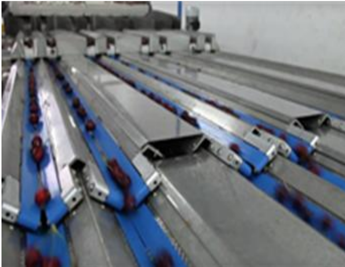
Keilleistenbänder in Wasch- und Sortiereinheiten für Obst.
