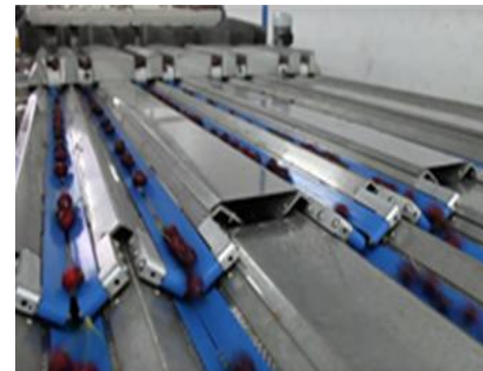
Keilleistenbänder in Wasch- und Sortiereinheiten für Obst.
