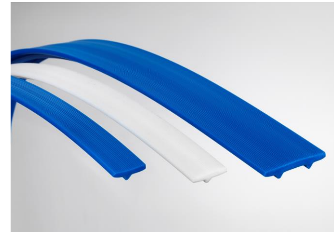
Die Längsrille reduziert die Kontaktfläche zum Transportgut und verbessert die Wasserablaufgeschwindigkeit.
