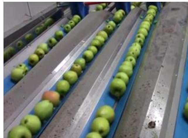
Längsgerillte Keilleistengurte beim Transport von Kirschen und Äpfeln von der Wascheinheit zur Größensortierung.
