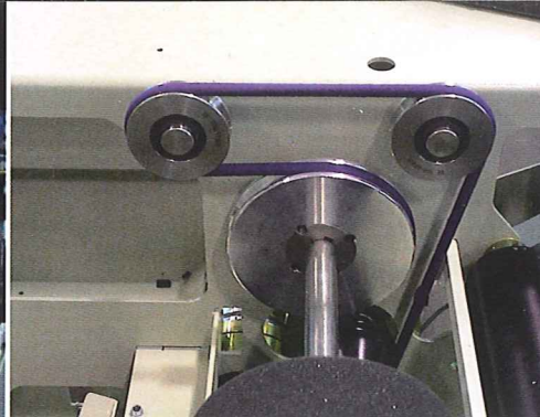
Walzenantrieb in einer Wäschefaltmaschine
