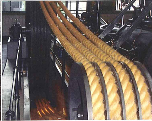
50 mm Transmissionsseile um 1910 aus Langhanf
