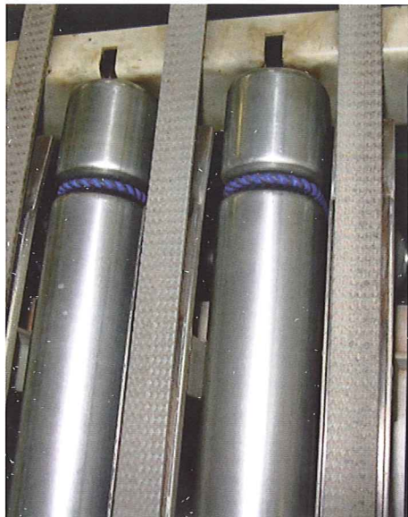
Förderantriebsrollen in der Fördertechnik
