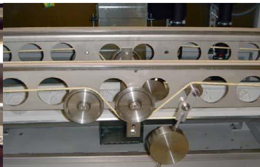
Vulkollan-Rundriemen in einem Etikettendruckwerk Gedrehte Rundriemen aus Kevlar in einer Transportstrecke für Abdeckrahmen
