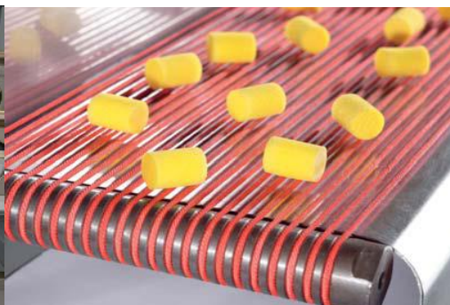
Polyester Rundriemen PVA rot in einer Transportvorrichtung
