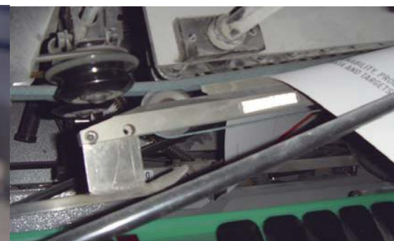
2 mm Polyester-Rundriemen in einer Falzmaschine für Papier
