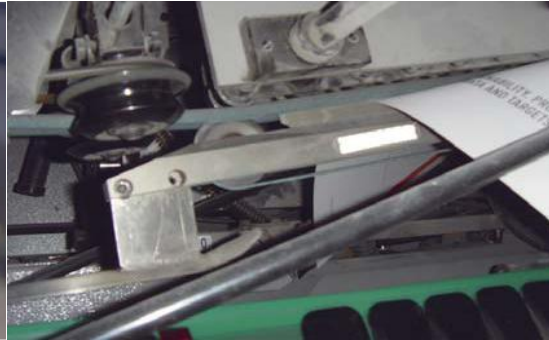
2 mm Polyester-Rundriemen in einer Falzmaschine für Papier
