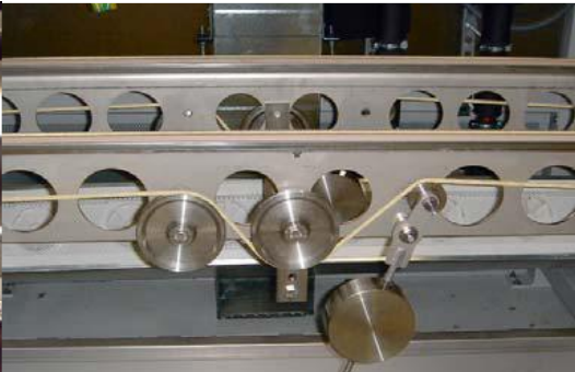
Gedrehte Rundriemen aus Kevlar in einer Transportstrecke für Abdeckrahmen
