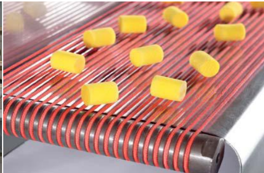
Polyester Rundriemen PVA rot in einer Transportvorrichtung
